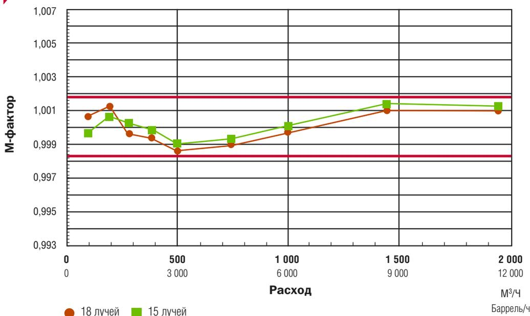
■ Благодаря конфигурации ультразвуковых лучей FH8500, точность измерений продолжает соответствовать рекомендациям API для коммерческого учета и после отключения одного из датчиков отображающего 3 ультразвуковые траектории
