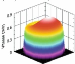
Пример реконструкции трехмерного профиля скоростей посредством 18 ультразвуковых лучей FH8500
