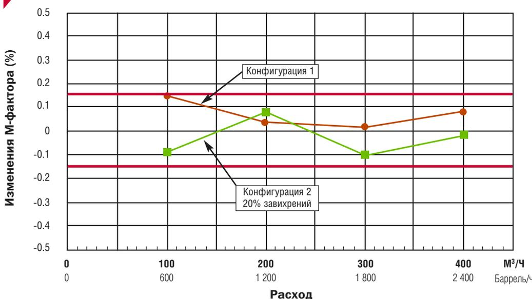
■ Благодаря уникальной трехмерной симметричной конфигурации лучей, точность счетчика FH8500 удовлетворяет требованиям международных стандартов даже при наличии в трубе завихрений и асимметричных профилей
