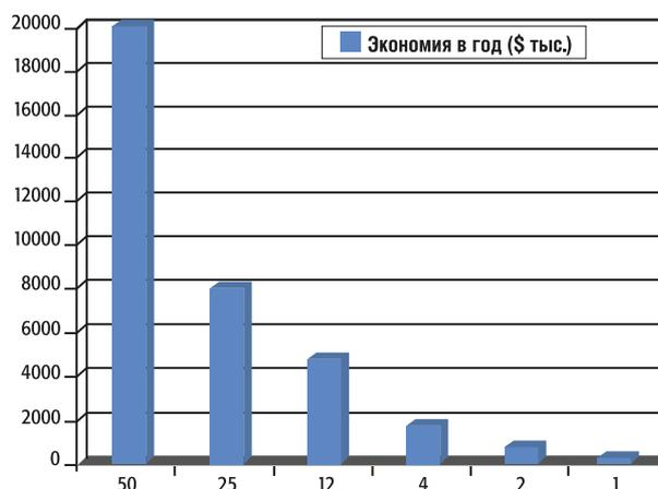
■ Снижение перепада давления (фильтр + струевыпрямитель + счетчик) по сравнению с турбинными и PD-счетчиками минимизируют потребление энергии на узле учета
