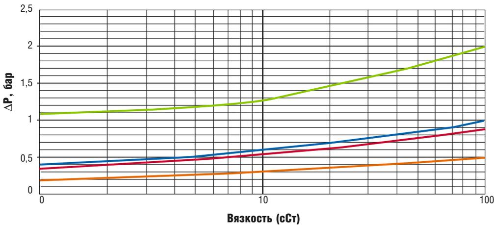
● Кориолисовый массовый расходомер ● PD счетчик ● Традиционный турбинный расходомер ● Расходомер HELIFLU
